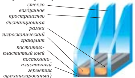
Рисунок. Двухкамерный стеклопакет
